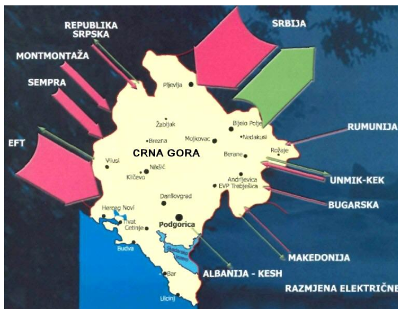
Slika 16. Šema strukture i obima razmjene električne energije u Crnoj Gori sa okruženjem u 2003. godini.
