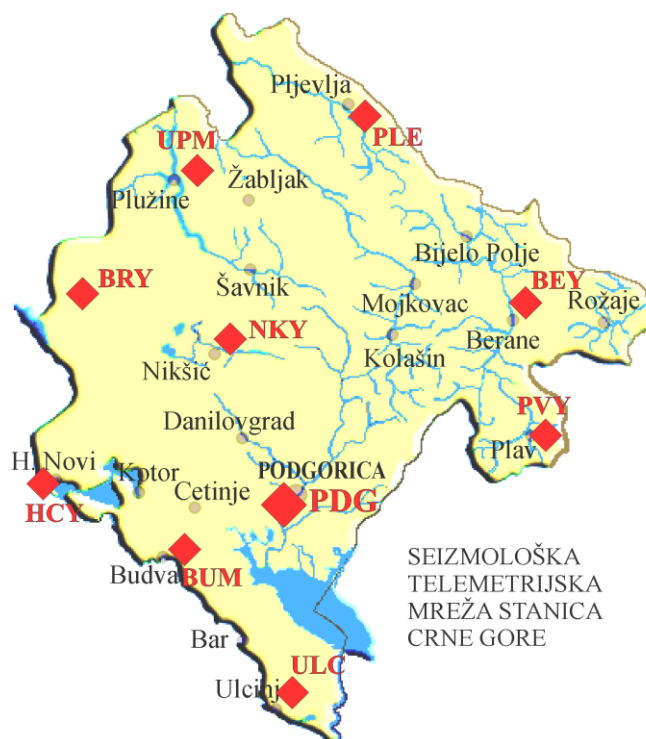
Slika 17. Struktura automatske seizmološke telemetrijske mreže stanica Crne Gore (oznake stanica su internacionalne).
